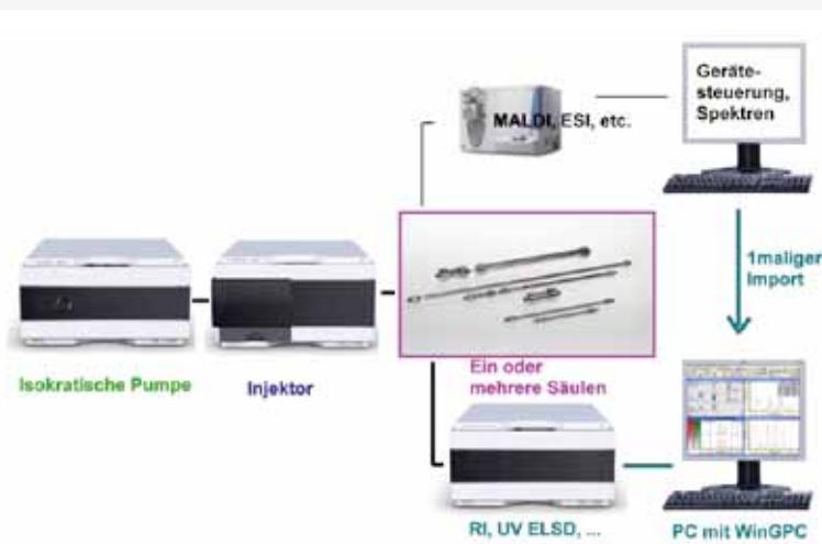
GPC/SEC-MS-Kopplung (schematisch): Nach der Trennung wird der Fluß gesplittet, dabei fließt der größere Teil des Stroms durch den Konzentrationsdetektorzweig, nur ein kleiner Teil fließt in das MS. Die MS-Spektren werden separat aufgenommen und danach in die WinGPC importiert.
