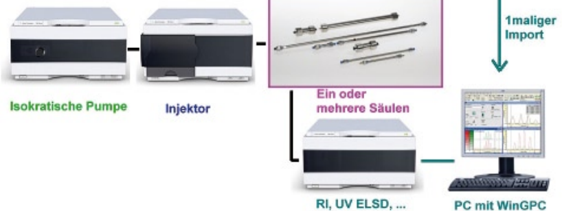
Abb. 1: GPC/SEC-MS-Kopplung (schematisch): Nach der Trennung wird der Fluß gesplittet, dabei fließt der größere Teil des Stroms durch den Konzentrationsdetektorzweig, nur ein kleiner Teil fließt in das MS. Die MS-Spektren werden separat aufgenommen und danach in die WinGPC importiert.
