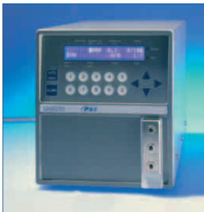
Abb. 2: Neuer Refraktometer zur dn/dc-Bestimmung
