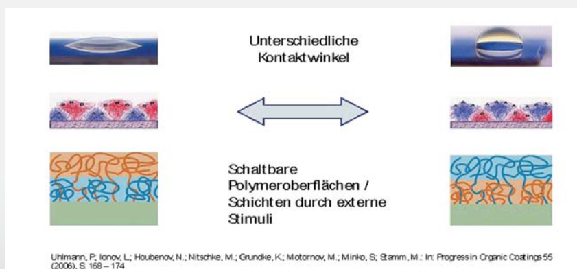
Schematische Darstellung der schaltbaren Polymeroberflächen und die Auswirkungen auf den Kontaktwinkel eines Wassertropfens.
