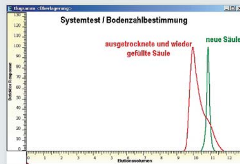
1 Elutionsprofile für BHT (Bodenzahltest) auf einer ausgetrockneten und nicht richtig wieder gefüllten Säule (rot) im Vergleich zu einer richtig konditionierten Säule (grün). Durch Kanäle in der Säule eluiert BHT deutlich früher und breiter.
